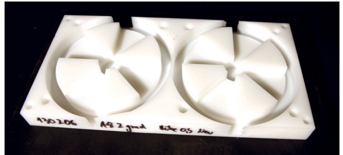
Bild 11 Stirnplattenschalung aus CNC gefrästem Polyoxymethylen (POM) zur Formung des Trockenstoßbereichs CNC milled face plate formwork from polyoxymethylene (POM) forming of the dry joint contact area
