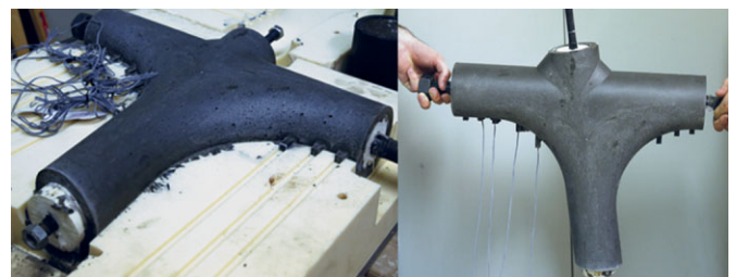
Bild 21 Ausschalen des Knotens (links) und leichter UHPFRC-Knoten (rechts) Stripping of the node (left) and light UHPFRC node (right)
